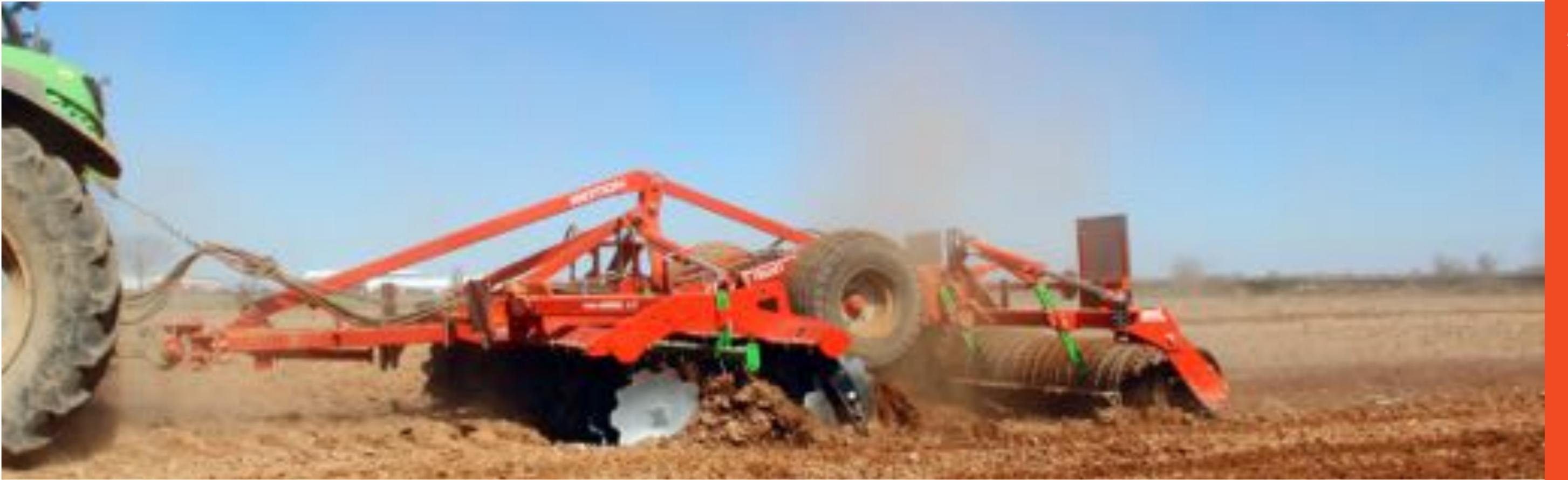
**“Индивидуальные стойки на каждый диск установлены на раму через эластичные приставки, шасси исполнено в двух вариантах прицепной и навесной”**
