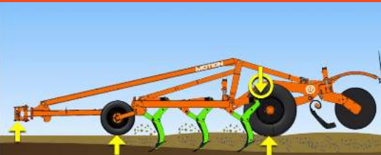
Las ruedas principales pueden aliviar la compactación.
